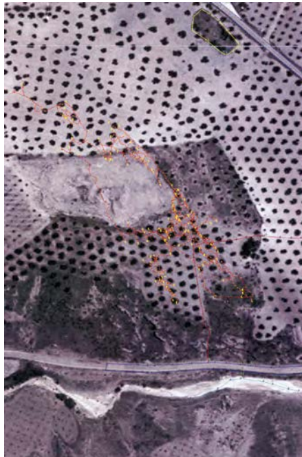
Figura 9. Topografía de la Cueva del Yeso trazada sobre la ortofoto.
