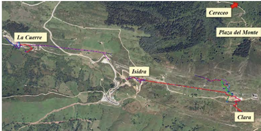
Figura 3. Superposición de la poligonal interior y la ortoimagen correspondiente.
