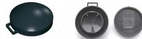
Figura 1. Contenedor del detector de radón CR-39 cerrado (izquierda) y abierto (derecha).
