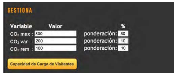
Figura 3. Variables y valores asignados junto con el peso en porcentaje para un caso experimental. El mayor peso (80%) se le otorga a la concentración máxima de CO 2 con un valor hasta 800 ppm. La variación de CO 2 desde que se abre la cavidad al público hasta que se cierra, también es una variable a la que se le da un peso considerable (20%) en este caso.
