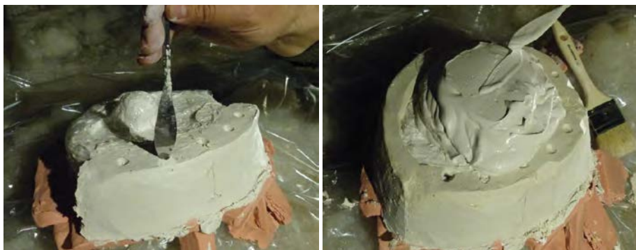
Figura 7. Fabricación de las cuatro piezas de la carcasa de escayola y sus llaves correspondientes.
