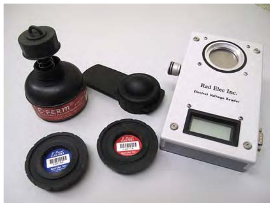
Figura 1. Sistema E-Perm. Arriba, de izquierda a derecha: cámara de iones para mediciones de corto plazo, cámara de iones para mediciones de largo plazo, lector de voltaje. Abajo, de izquierda a derecha: electrete de corto plazo y electrete de largo plazo.
