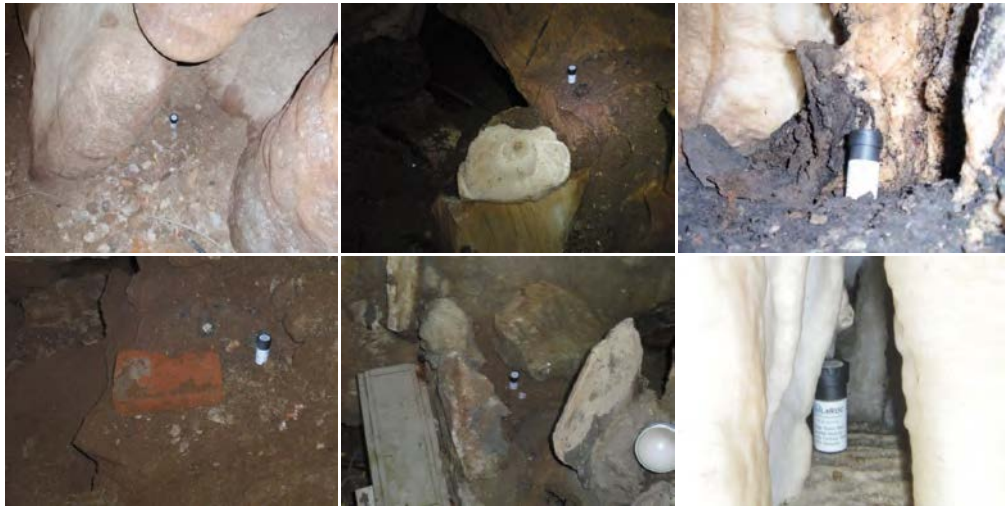
Figura 1. Fotografías de algunos de los detectores pasivos de Radón instalados en la Gruta de las Maravillas, facilitados por la Universidad de Cantabria.
