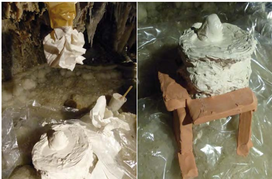
Figura 6. Detalle de la palmatoria recubierta de silicona e inicio de la base para la construcción de la carcasa.
