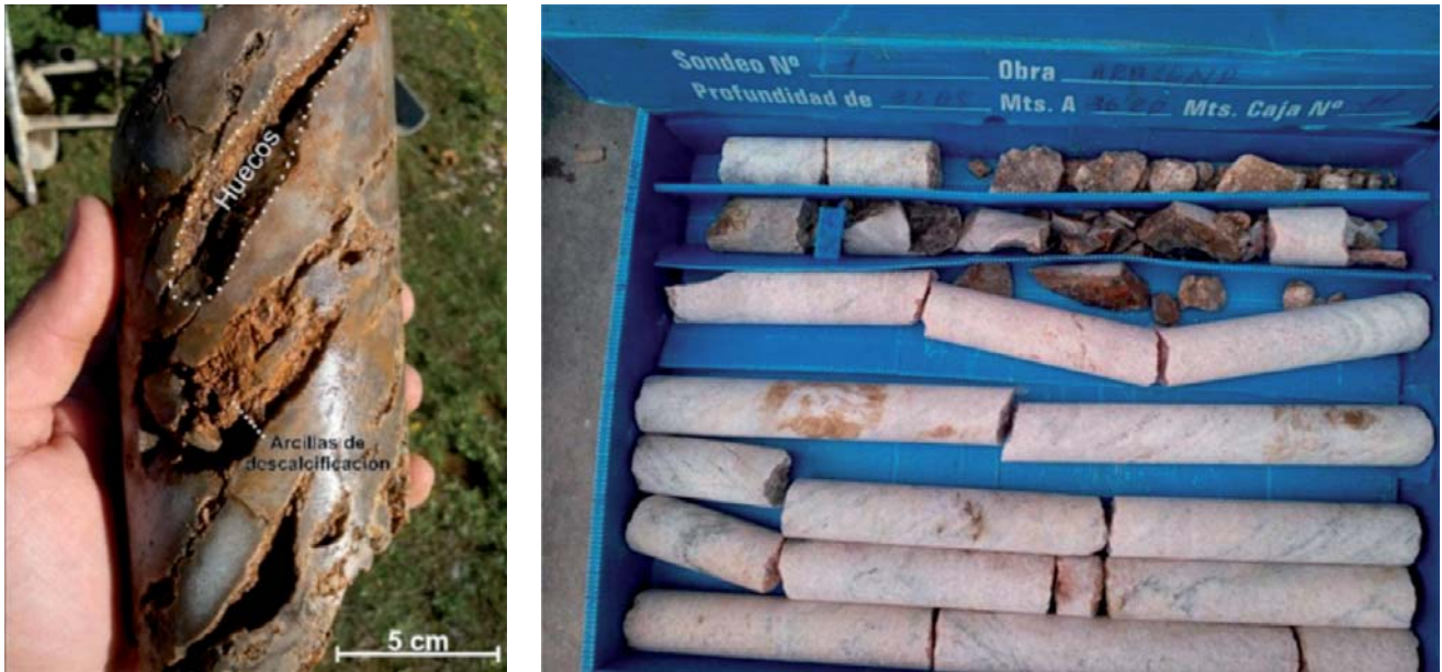
Figura 5. Perforación del sondeo 1. Muestra de mano de cuarcita con venas disueltas y arcillas de descalcificación rellenando los huecos (izquierda). Detalle de los mármoles interceptados a profundidades comprendidas entre los 32 y 36 m (derecha)
