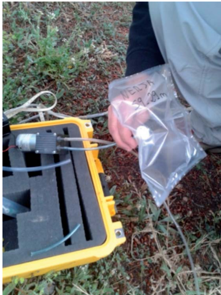
Figura 3. Extracción de CO 2(g) en el sondeo 9 mediante una bomba de diafragma KNF
