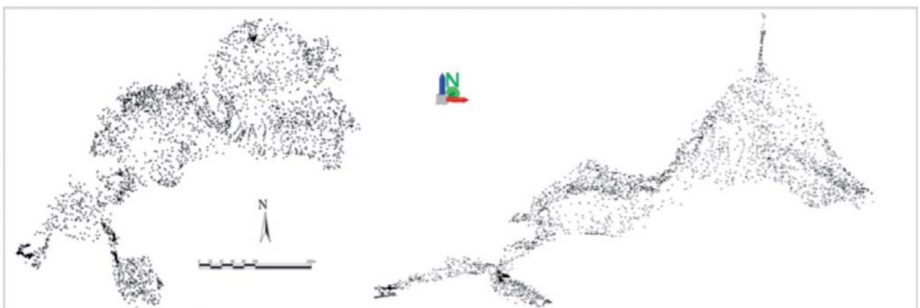
Figura 6: Imagen de la nube de puntos obtenida con el DistoX2 usada en la topografía espeleológica
