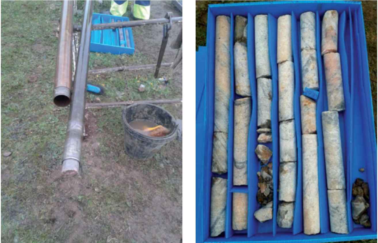
Figura 2. Tubo porta testigos (izquierda) y testigos de roca obtenidos en la primera de las perforaciones (sondeo1) realizadas en el cerro del Castillo (Fotografías: W. Martín)
