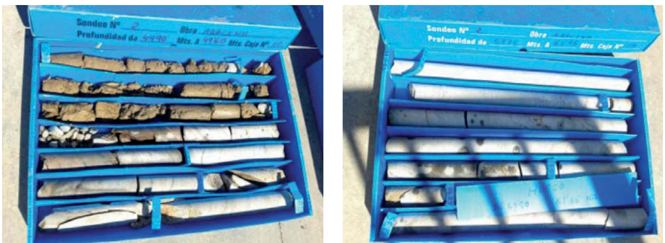
Figura 6. Cajas de testigos correspondientes a las profundidades 44,9-49,60 (izquierda) y 57,75-61,95 (derecha)
