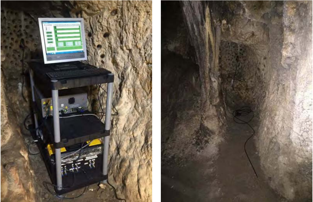
Figura 5. Izq. Vista del tunel con cable introducido en la perforación; dcha. Instalación del equipo y sus componentes en la localización (Sala del Cataclismo).
