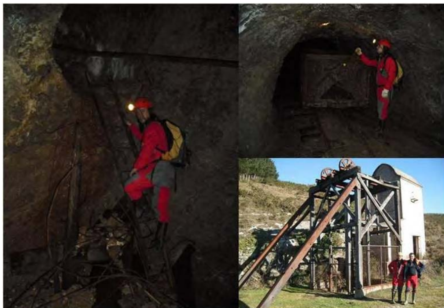
Figura 5. Mina La Cuerre. Entronque del plano inclinado de entrada a la galería Elvira en dirección E – O (izquierda); vagoneta en el ramal Oeste de la galería Elvira (derecha arriba); castillete de la mina (derecha abajo).
