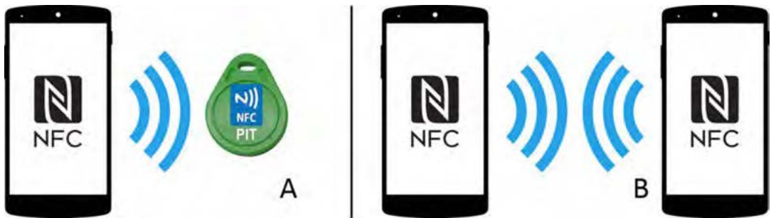
Figura 6. Sistema de envío de datos y energía. A: dispositivos activo-pasivo; el dispositivo activo envía energía y datos al dispositivo pasivo (etiqueta o colgante). B: dispositivos activo-activo; los dos dispositivos tienen capacidad de enviar energía y datos.
