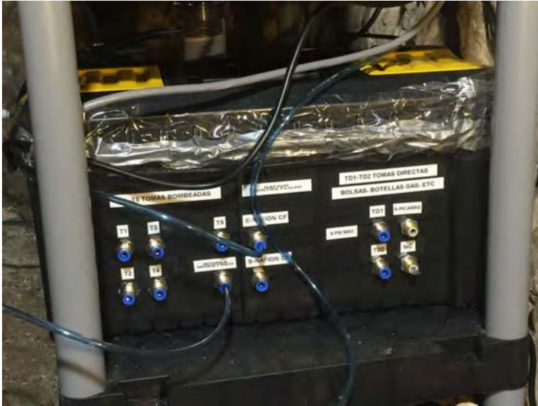
Figura 3. Lateral de la caja multiválvulas con las conexiones de los distintos componentes del equipo PICARRO G2201-i.
