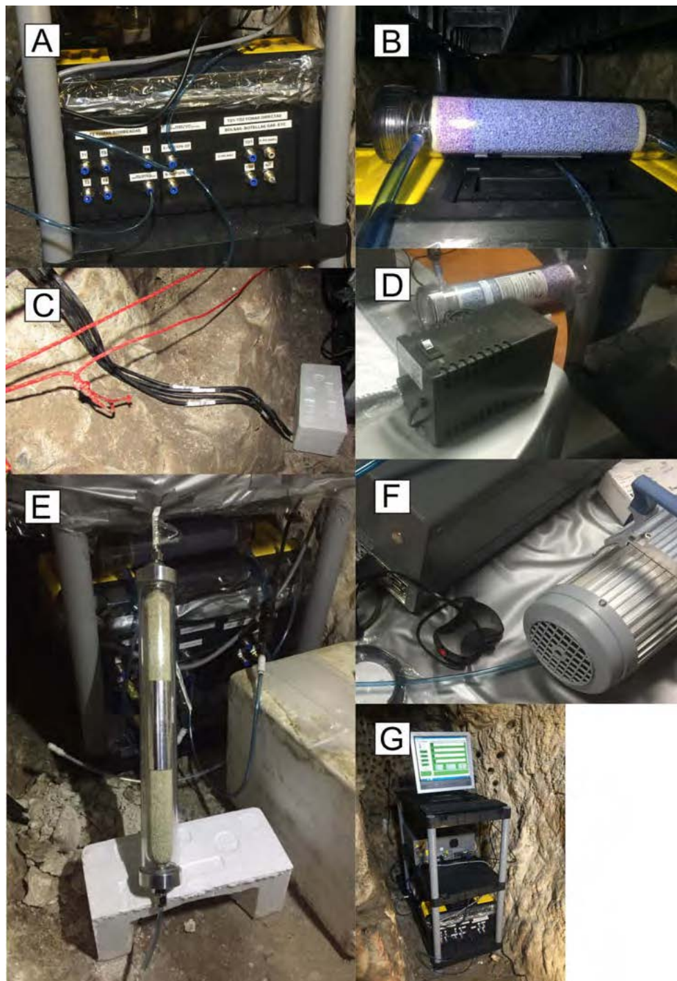
Figura. 1. A) Sistema de válvulas solenoides; B) Sistema desecante Drierite; C) Capilares de 6 mm de aluminio revestido; D) Bomba de arrastre; E) Trampa de CO 2 ; F) Bomba de acuario y bomba de vacío; G) Teclado, pantalla y estantería.
