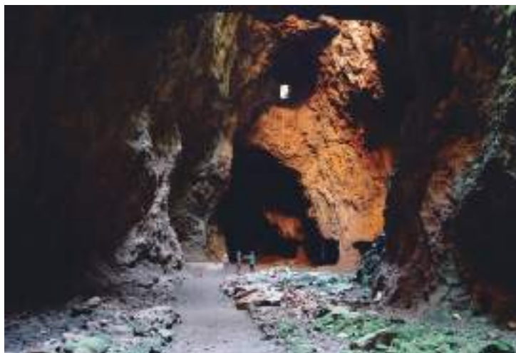
Figura 4. Cámara principal en la mina de La Jayona. Se aprecia un subnivel superior de desarrollo de la cámara.
