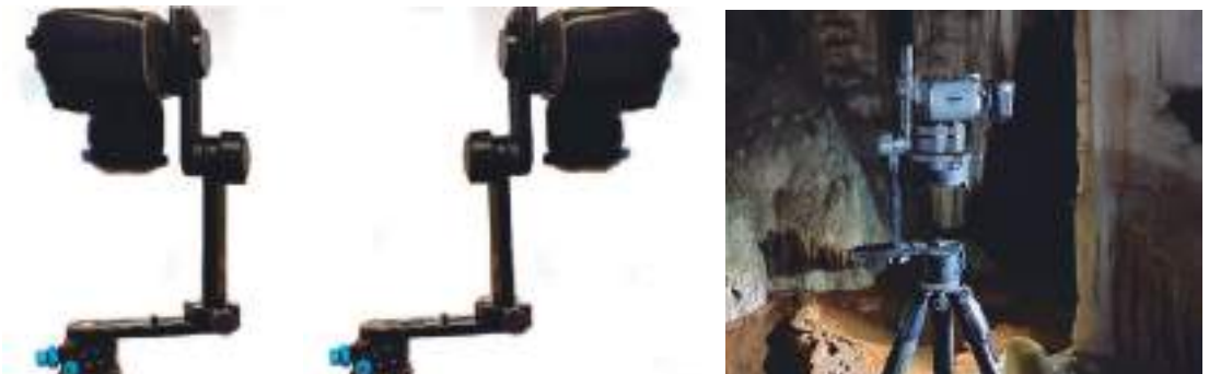
Figura 3. Posición de la cámara para obtener el nadir y poder eliminar el trípode en 2 fotos.
