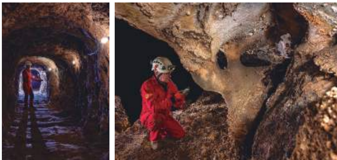
Figura 3. Galería minera de dirección Este-Oeste para cruzarse con las brechas de mineral de dirección Sur-Norte (izquierda). Galería natural con morfologías hipogénicas (derecha).
