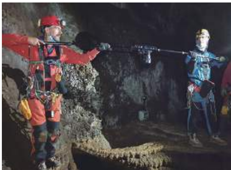
Figura 4. Modo para obtención del nadir sin trípode, alternativo al sistema de la rótula.
