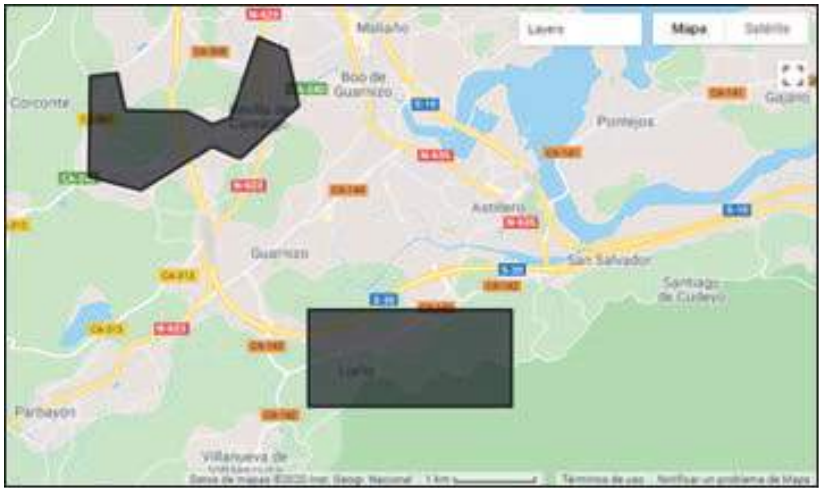
Figura 6. Polígono superior: zona afectada por dolinas; polígono inferior: zona sin evidencias de hundimientos
