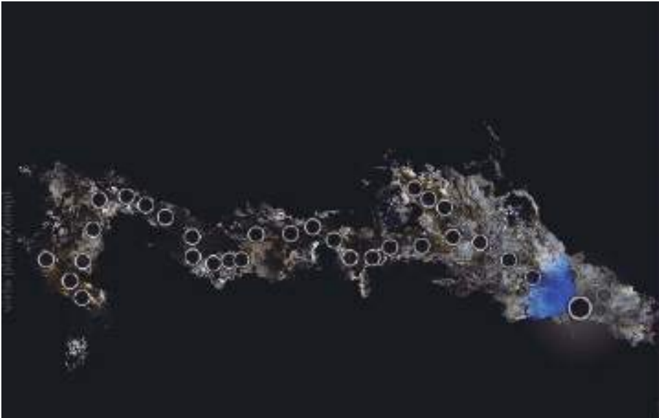
Figura 4. Estacionamientos realizados durante la toma de datos con la cámara Matterport.
